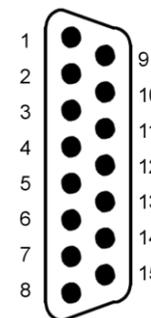
Schrittmotor-, Oszillationsmotor- und 12V-Ausgang sind kurzschlussfest. Da die 12V-Versorgung auch intern verwendet wird, sind jedoch Fehlfunktionen der Steuerung im Kurzschlussfall möglich. Pin 5 und 14-15 (Masse) sind intern verbunden, sollten aber getrennt verlegt werden, um Störungen der Endschaltersignale durch den Motor auszuschließen. Der Endschalter kann ein Öffner oder Schließer nach Masse sein. Die Polarität kann in der Software (z.B. WinPCNC oder Mach3) ausgewählt werden.
