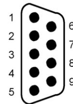
Bei Motoren mit 3A oder höherem Strom muss ein Kabelquerschnitt von mindestens 0,5mm<sup>2</sup> verwendet werden, und je Ader immer beide Pins angeschlossen werden. Bei Motoren mit kleinerem Strom ist 0,34mm<sup>2</sup> und ein Pin ausreichend. Die Abschirmung kann alternativ an Pin 5 oder den Blechkragen des Steckers angeschlossen werden. Die Motorausgänge sind kurzschlussfest (Windungs- und Masseschluss).
