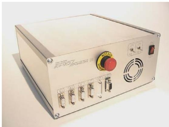
*Abb. 9: Schrittmotorsteuerung*
