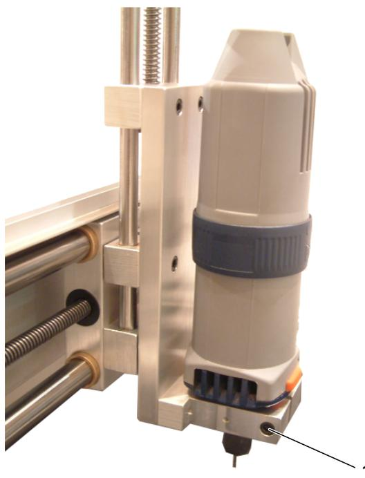
Abb. 12: Werkzeugaufnahme am Z-Schlitten
